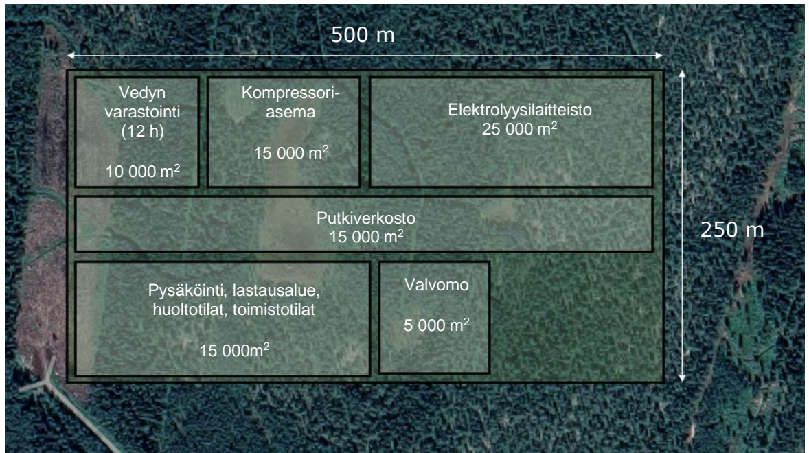
Kuva 2-11. Esimerkki maalla sijaitsevan vetylaitoksen pohjapiirroksesta.
