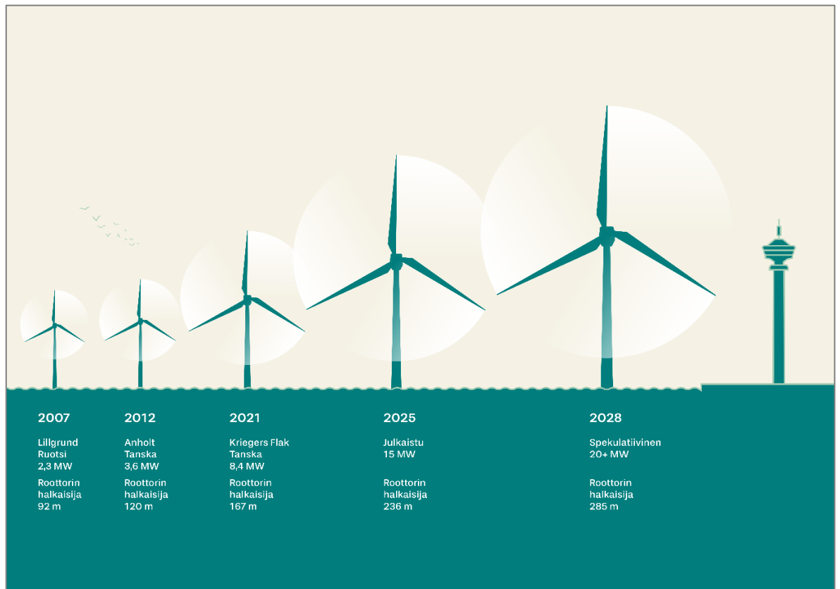
Kuva 1-5. Havainnollistus merituulivoimateknologian kehityksestä vuodesta 2007 2,3 MW voimaloista tänä päivänä julkaistuihin 15 MW voimaloihin sekä ennusteita tulevien vuosien voimalateknologian kehityksestä yli 20 MW voimaloihin. Näsinneula kuvassa oikealla tuomassa mittasuhdetta kokoluokkaan, Näsinneulan kokonaiskorkeus antennin päähän on 168 metriä.
